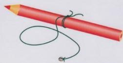
Подвесьте кристаллик в стакане так, чтобы был погружен в раствор, но не касался стенок и дна.
